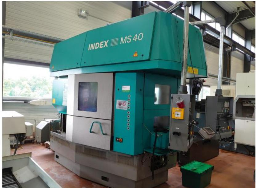
Multispindel CNC Drehautomat, ausgerüstet für Nacharbeit
